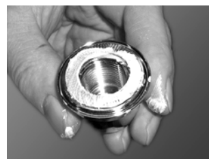
Rys. 26 Podkładka Nord-Lock w nakrętce wirnika
