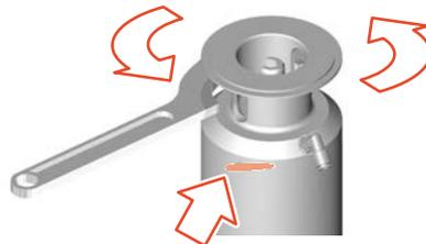
Abb.82: Montagefeder lösen
