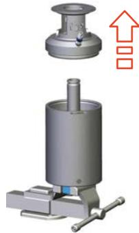
Abb.91: Antriebsunterteil entfernen
