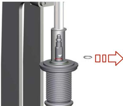
Abb.48: Sicherungsring entnehmen
