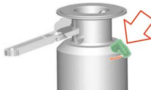
Abb.90: Luftanschluss platzieren
