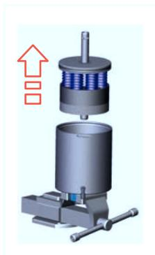
Abb.85: Federpaket herausheben
