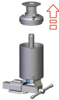
Abb.84: Antriebsunterteil entfernen
