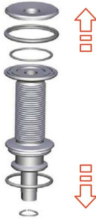
Abb.53: Dichtungen demontieren
