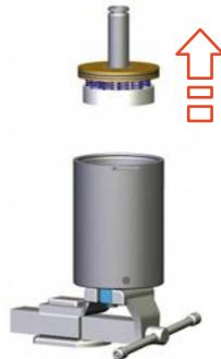
Abb.92: Oberes Federpaket herausheben
