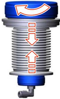
Abb.73: Abdruckgehäuse festschrauben
