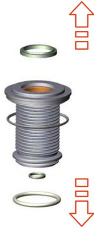
Abb.51: Dichtungen demontieren
