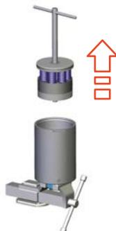
Abb.93: Unteres Federpaket herausheben
