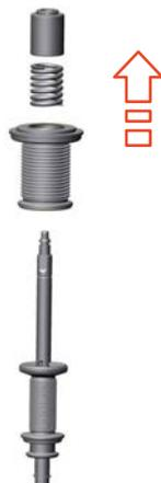
Abb.50: Obere Bestandteile abziehen
