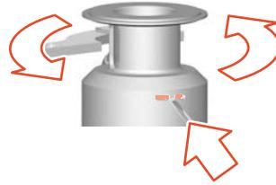
Abb.89: Montagefeder befestigen
