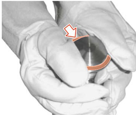
Abb.64: Ventilsitzdichtung aufziehen
