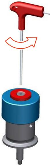
Abb.48: Senkschraube lösen
