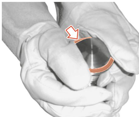
Abb.34: Ventilsitzdichtung aufziehen
