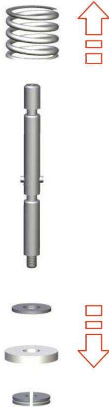
Abb.51: Antriebskomponenten abziehen
