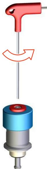
Abb.57: Senkschraube lösen
