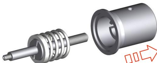
Abb.50: Antriebszylinder abziehen
