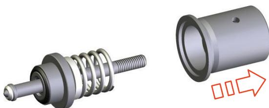
Abb.59: Antriebszylinder abziehen
