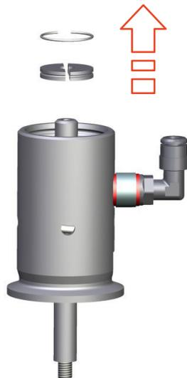
Abb.42: Sicherungselemente entfernen
