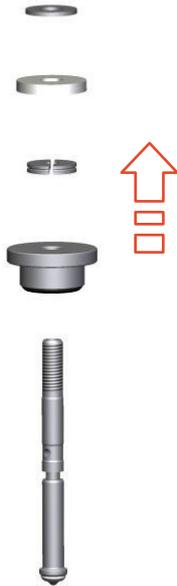
Abb.68: Antriebskomponenten abziehen
