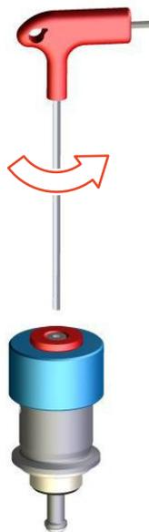
Abb.62: Senkschraube lösen
