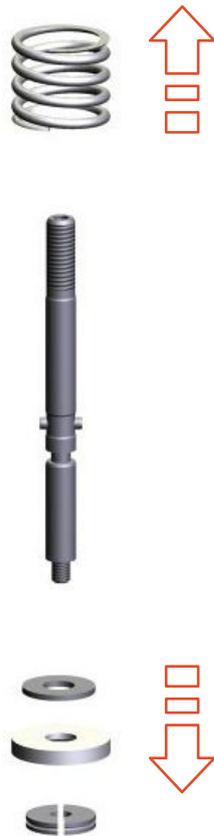
Abb.56: Antriebskomponenten abziehen
