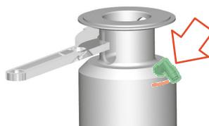
Fig.69: Colocación de la conexión de aire
