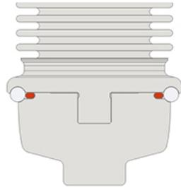
Fig.6: Sistema "divisible" para materiales de junta duros
