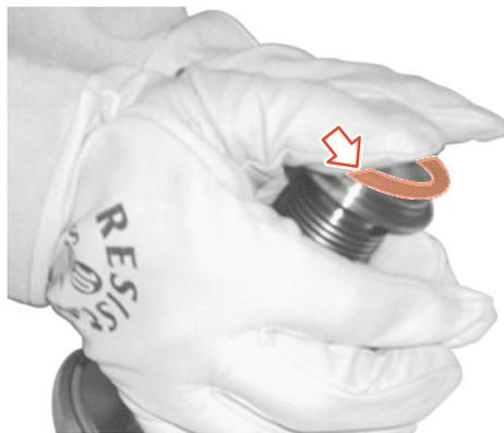
Fig.42: Colocación de la junta de asiento de la válvula en la ranura
