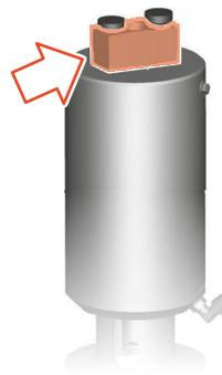
Fig.59: Colocación de la pieza de sujeción
