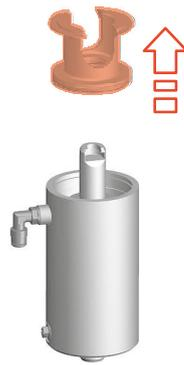
Fig.54: Retirar la parte inferior del accionamiento
