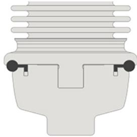
Fig.7: Sistema "divisible" para materiales de junta elásticos
