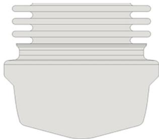
Fig.4: Sistema «sin junta del asiento de la válvula»
