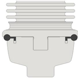
Abb.7: System „teilbar“ für Elastomer Dichtungsmaterialien
