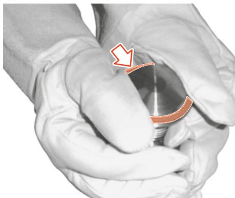
Abb.43: Ventilsitzdichtung aufziehen
