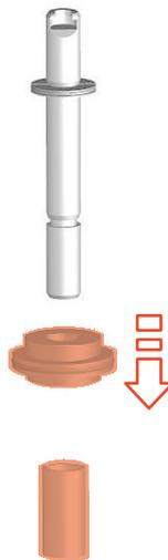
Abb.58: Antriebskomponenten abziehen
