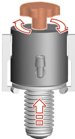
Fig.43: Fissaggio della parte interna
