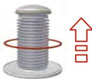
Fig.33: Rimozione della guarnizione dell'alloggiamento
