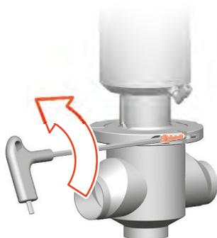
Fig.29: Rimozione della vite della clamp
