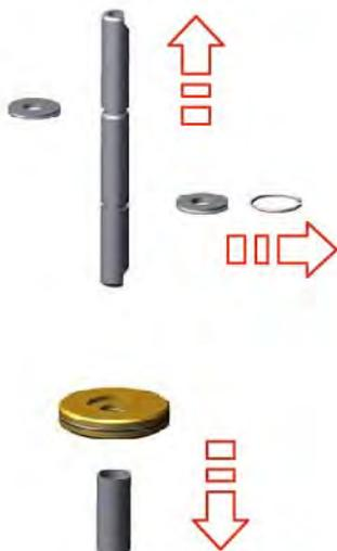
Fig.54: Rimozione degli elementi di bloccaggio e dei componenti dell'attuatore
