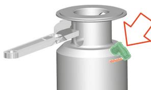
Fig.59: Posizionamento dell'allacciamento dell'aria
