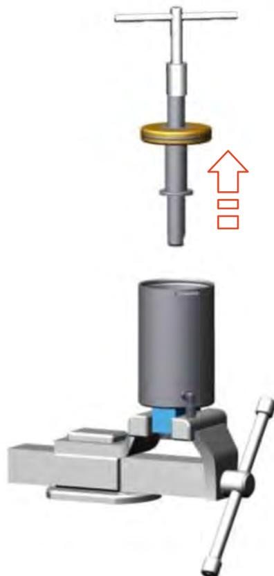
Fig.53: Estrazione dei componenti dal cilindro
