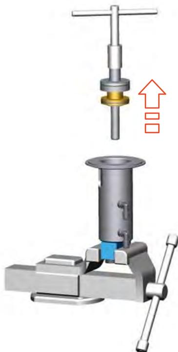
Fig.48: Estrazione dei componenti dal cilindro
