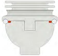
Fig.6: Sistema "divisibile" per materiali delle guarnizioni duri
