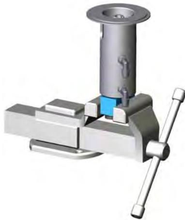
Fig.46: Serraggio del pezzo di serraggio nella morsa
