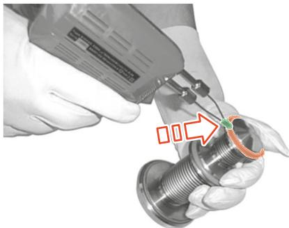
Fig.34: Taglio della guarnizione della sede della valvola
