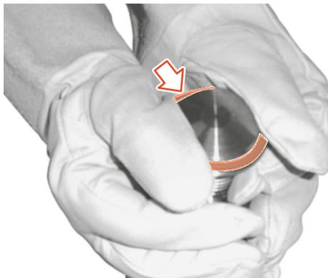
Fig.37: Applicazione della guarnizione della sede della valvola
