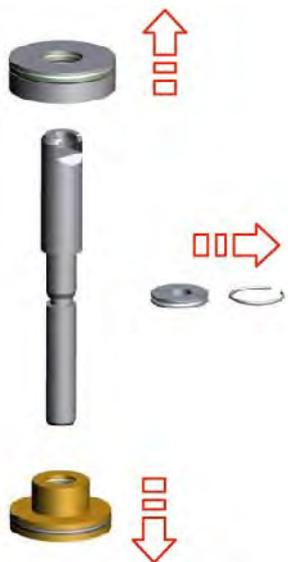
Fig.49: Rimozione degli elementi di bloccaggio e dei componenti dell'attuatore
