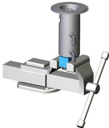
Fig.46: Serrer l'élément de serrage dans l'étau
