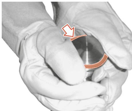
Fig.37: Insérer le joint de vanne à siège
