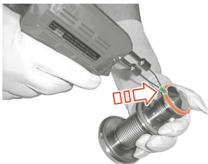
Fig.34: Séparer le joint de vanne à siège
