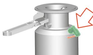
Fig.59: Positionner le raccord d'air
