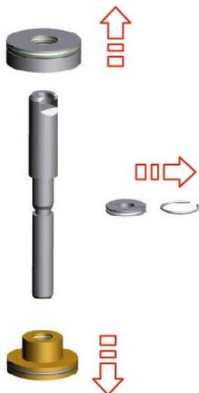
Fig.49: Retirer les éléments de sécurité et les composants du mécanisme
