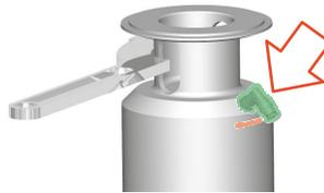
Fig.59: Colocación de la conexión de aire
