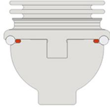
Fig.6: Sistema "divisible" para materiales de junta duros
