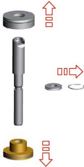
Fig.49: Eliminar los elementos de seguridad y componentes de accionamiento
