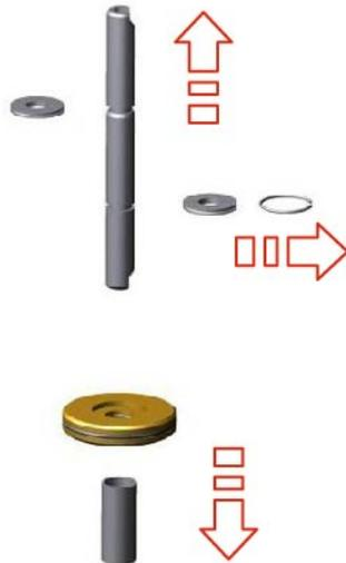
Fig.54: Eliminar los elementos de seguridad y componentes de accionamiento
