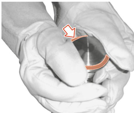
Fig.37: Colocación de la junta de asiento de la válvula
