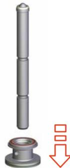
Abb.75: Antriebsunterteil abziehen
