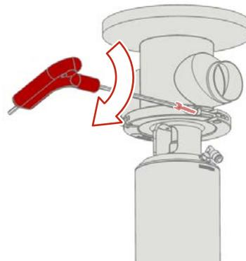
Abb.58: Innenteil zentrieren und befestigen
