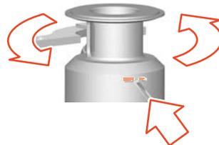
Abb.120: Montagefeder befestigen
