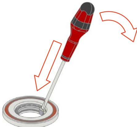
Abb.64: Kolbenstangendichtung entfernen
