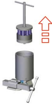
Abb.113: Unteres Federpaket herausheben
