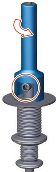
Abb.100: Öffnung zu Leckagestutzen ausrichten
