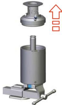
Abb.111: Antriebsunterteil entfernen
