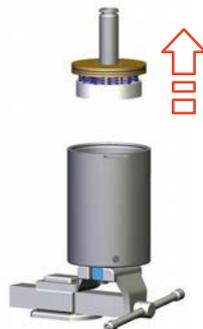
Abb.112: Oberes Federpaket herausheben
