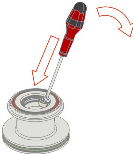
Abb.78: Kolbenstangendichtung entfernen
