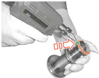
Fig.83: Séparer le joint de vanne à siège
