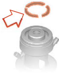
Fig.119: Retirer les éléments de sécurité
