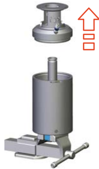
Fig.105: Retirer la partie inférieure de l'actionneur
