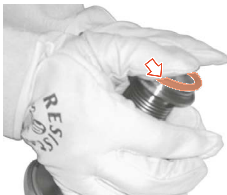
Fig.85: Placer le joint de vanne à siège dans la rainure
