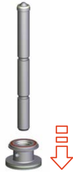
Fig.69: Dégager la partie inférieure de l'actionneur
