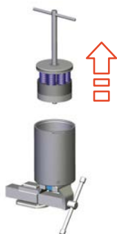
Fig.107: Extraire l'ensemble des ressorts inférieur
