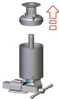
Fig.105: Retirar la parte inferior del accionamiento
