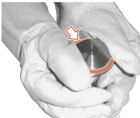
Fig.86: Colocación de la junta de asiento de la válvula
