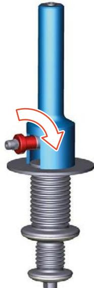
Fig.95: Atornillar el adaptador
