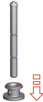
Fig.69: Extracción de la pieza inferior del accionamiento
