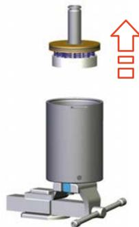
Fig.106: Extraer el bloque de muelle superior
