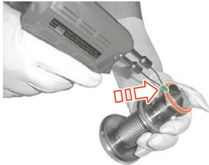
Fig.83: Extracción de la junta del asiento de la válvula
