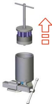
Fig.107: Extraer el bloque de muelle inferior
