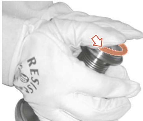
Fig.85: Colocación de la junta de asiento de la válvula en la ranura
