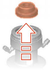
Abb.120: Kolbenteller herausheben
