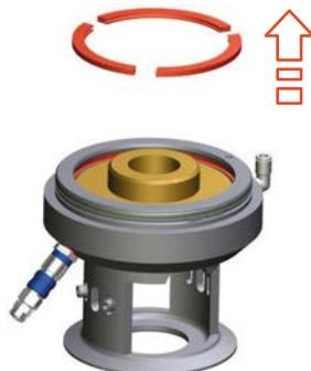
Abb.109: Sicherungselemente entfernen
