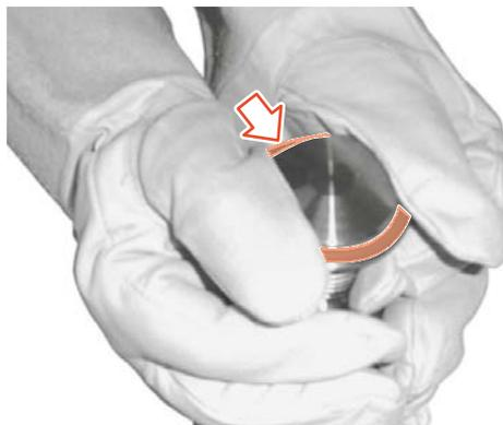
Abb.86: Ventilsitzdichtung aufziehen
