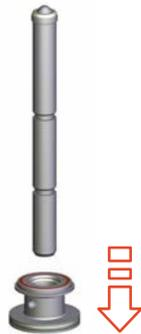
Abb.69: Antriebsunterteil abziehen
