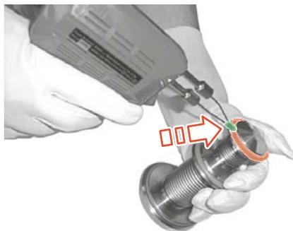
Abb.83: Ventilsitzdichtung auftrennen
