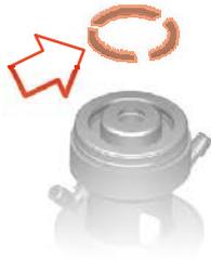
Abb.119: Sicherungselemente entfernen
