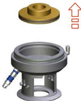
Abb.110: Kolbenteller herausheben
