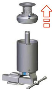
Abb.105: Antriebsunterteil entfernen
