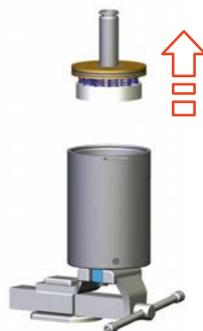
Abb.106: Oberes Federpaket herausheben
