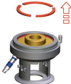
Abb.100: Sicherungselemente entfernen
