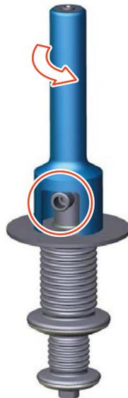
Abb.89: Öffnung zu Leckagestutzen ausrichten
