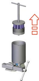
Abb.98: Unteres Federpaket herausheben
