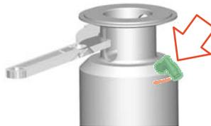
Abb.106: Luftanschluss platzieren
