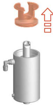
Abb.71: Antriebsunterteil entfernen
