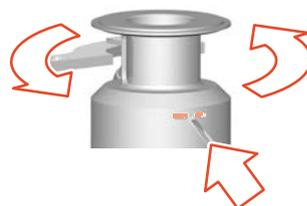
Abb.105: Montagefeder befestigen
