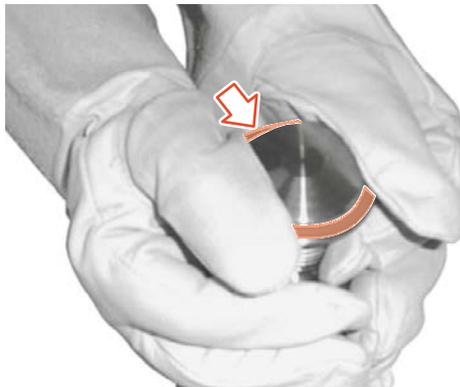
Abb.84: Ventilsitzdichtung aufziehen
