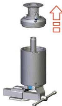
Abb.96: Antriebsunterteil entfernen
