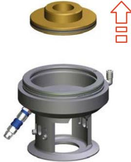
Abb.101: Kolbenteller herausheben
