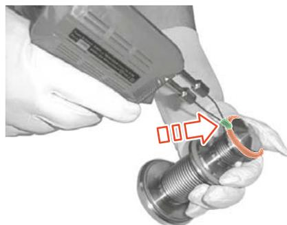
Abb.81: Ventilsitzdichtung auftrennen
