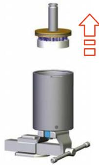
Abb.97: Oberes Federpaket herausheben
