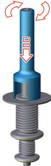
Abb.88: Abdruckwerkzeug aufschrauben
