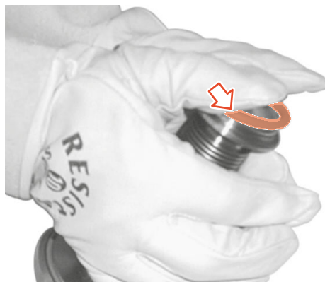
Abb.24: Ventilsitzdichtung in Nut platzieren
