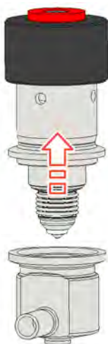
Abb.18: Antrieb und Innenteil entfernen
