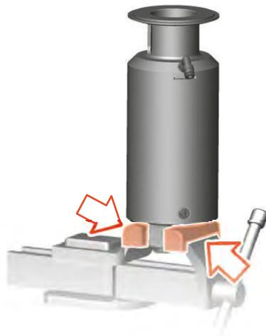
Fig.57: Serrer l'actionneur
