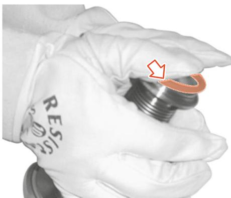
Fig.39: Placer le joint de vanne à siège dans la rainure
