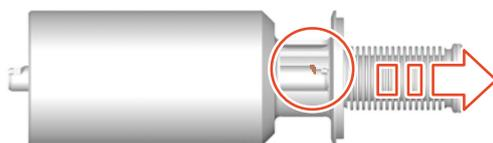
Fig.34: Dégager la tige du piston avec la rainure orientée vers le haut.
