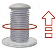
Fig.36: Retirer le joint du boîtier
