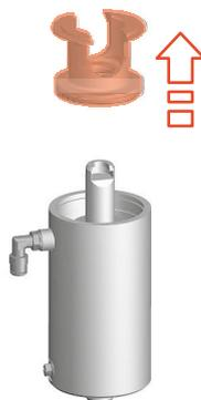
Fig.51: Retirer la partie inférieure de l'actionneur
