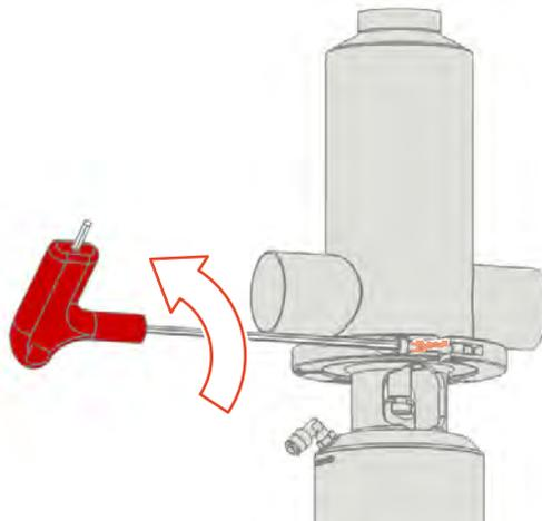
Fig.29: Desserrer la vis du collier de serrage
