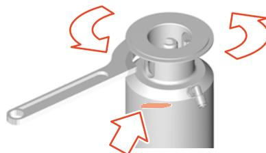
Fig.58: Desserrer le ressort de montage
