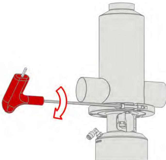
Fig.31: Monter le collier de serrage desserré
