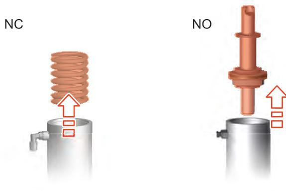
Fig.53: Extraire les composants inférieurs de l'actionneur
