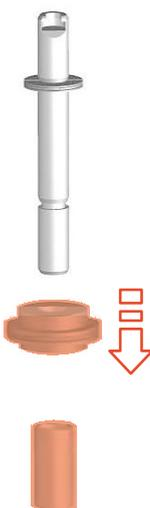
Fig.55: Extraire les composants de l'actionneur
