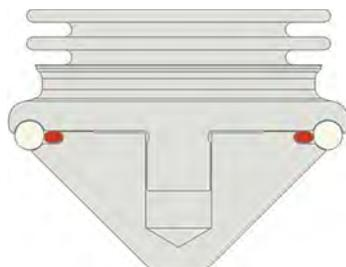
Fig.5: Système "divisible" pour des matériaux d'étanchéité durs
