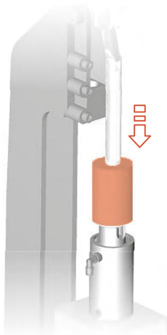
Fig.48: Abaisser la partie inférieure de l'actionneur
