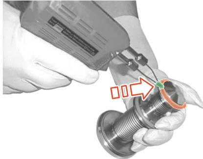
Fig.37: Séparer le joint de vanne à siège
