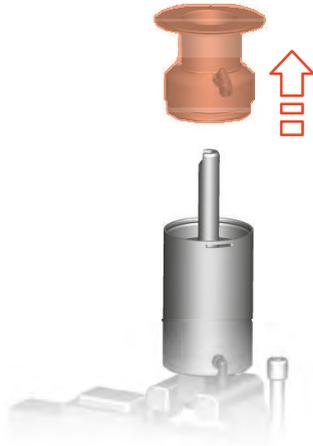
Fig.67: Retirer la partie inférieure de l'actionneur
