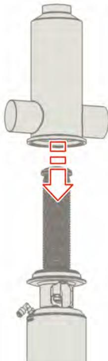
Fig.30: Retirer l'actionneur et la pièce interne
