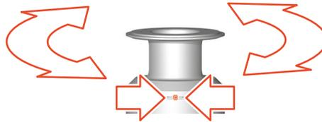
Fig.62: Orienter l'alésage par rapport à la rainure
