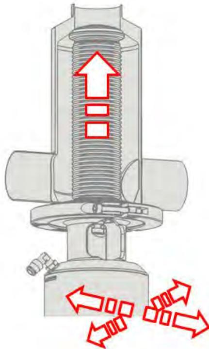
Fig.32: Centrer le joint de la vanne dans le siège de la vanne
