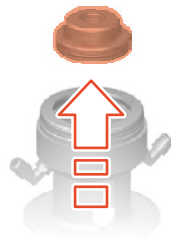
Fig.71: Elevar el disco del émbolo
