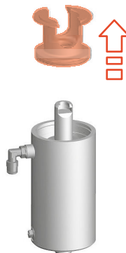
Fig.51: Retirar la parte inferior del accionamiento
