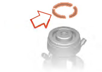
Fig.70: Retirar los elementos de seguridad
