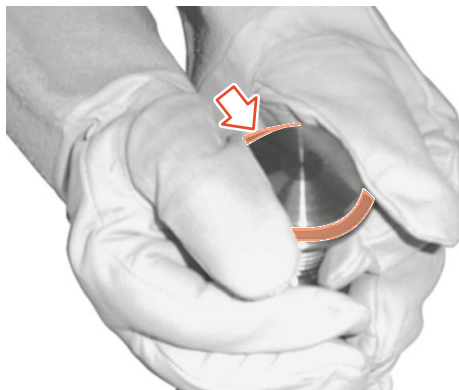
Fig.40: Colocación de la junta de asiento de la válvula
