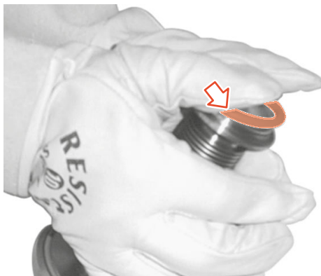
Fig.39: Colocación de la junta de asiento de la válvula en la ranura
