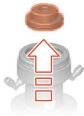
Abb.71: Kolbenteller herausheben
