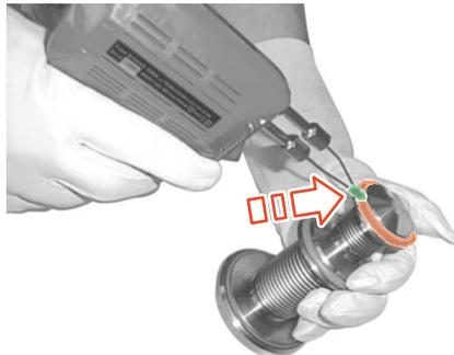
Abb.37: Ventilsitzdichtung auftrennen
