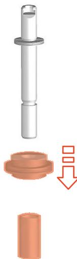
Abb.55: Antriebskomponenten abziehen
