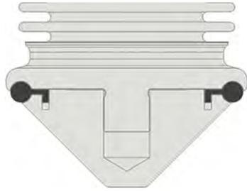
Abb.6: System „teilbar“ für Elastomer Dichtungsmaterialien
