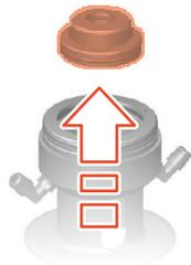
Abb.69: Kolbenteller herausheben
