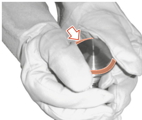
Fig.47: Insérer le joint de vanne à siège
