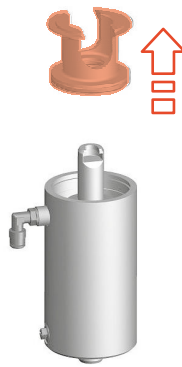
Fig.58: Retirer la partie inférieure de l'actionneur
