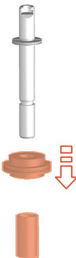
Fig.55: Estrazione dei componenti dell'attuatore
