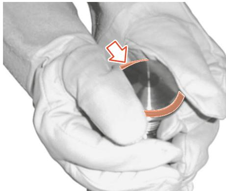
Fig.40: Applicazione della guarnizione della sede della valvola
