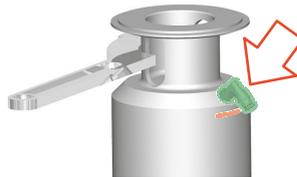
Fig.66: Posizionamento dell'allacciamento dell'aria
