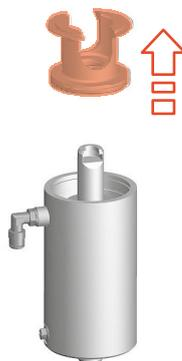
Fig.51: Rimozione della parte inferiore dell'attuatore
