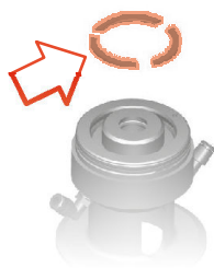
Fig.70: Retirer les éléments de sécurité
