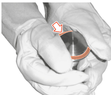
Fig.40: Insérer le joint de vanne à siège
