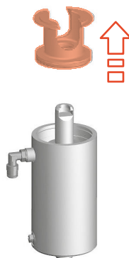
Fig.51: Retirer la partie inférieure de l'actionneur
