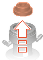
Fig.71: Extraire le disque de piston
