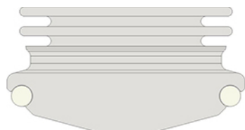
Fig.4: Sistema "zunchado en caliente"
