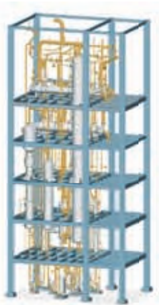
降膜逆流-涓流蒸发装置，带精馏单元，用于橄榄油精制。
