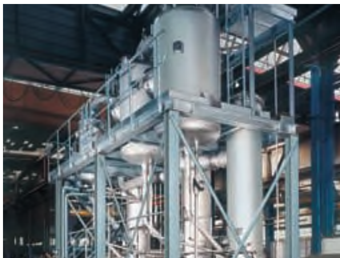
3效循环蒸发装置，用于甘油—水溶液蒸发。 蒸发量：3,600 kg/hr。
