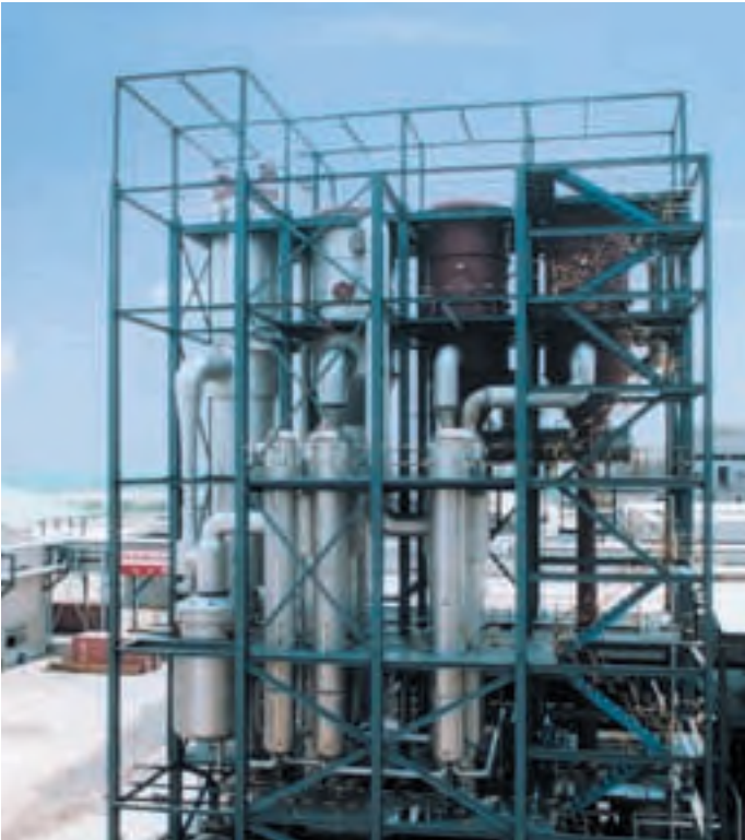
3效降膜强制循环蒸发装置，带热力蒸汽再压缩机，用于味精废水处理。 蒸发量：50 t/hr。
