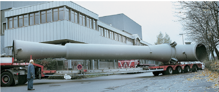
喷射泵，用于炼钢脱气的4级喷射真空泵 抽吸量：1,100 kg/h或1,387,000 m³/h，吸入压力：绝压0.6 mbar
