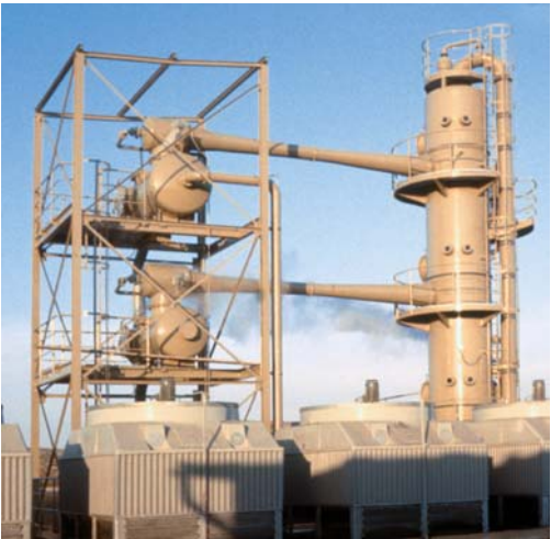
图9：桥式设计的3级蒸汽喷射制冷装置，可将194m 3 /hr水从28℃冷却至15℃。冷却能力：2900 kW
