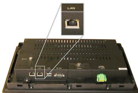
Abb.23: Ethernetschnittstelle (LAN) für Modbus-TCP und EtherNet/IP
