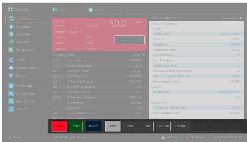
Abb.30: Leiste mit Steuerschaltflächen in der Hauptansicht der Verdichtersteuerung
