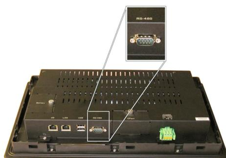
Abb.25: RS-485-Schnittstelle für Modbus-RTU, Allen-Bradley DF1, Benshaw-Motorstarter und Thermomaster
