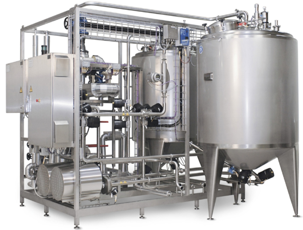
GEA CIP Unit
