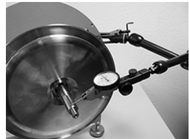
Afb.36: Opmeten van de pompas
