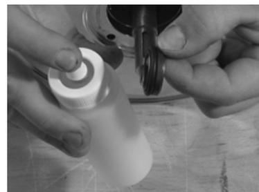
Fig.38: Anneau fixe de la garniture mécanique
