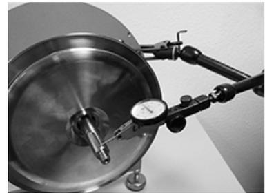
Fig.36: Mesurer l'arbre de la pompe
