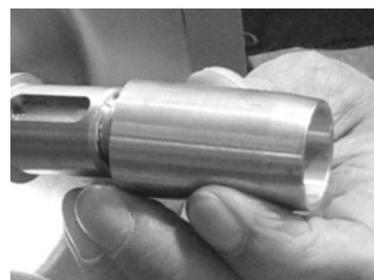
Fig.40: Douille de montage
