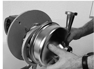
Fig.59: Logement du joint
