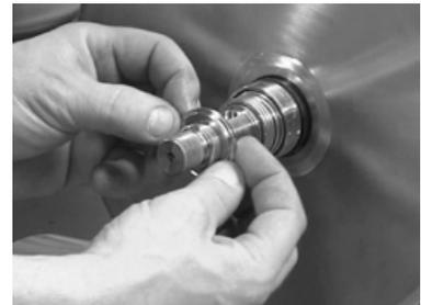
Fig.42: Rondelle d'étanchéité
