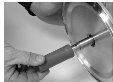
Fig.33: Douille de montage
